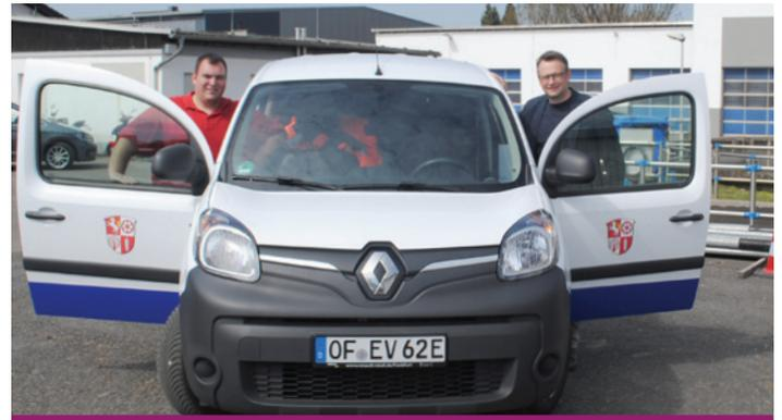
Die Fahrzeuge, auch BEV (Batterie Electric Vehicle) genannt, sind mit einer 33 kWh Batterie ausgestattet und verfügen über eine Reichweite von bis zu 230 Kilometern.
